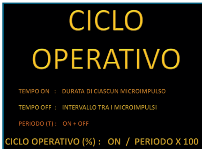
Fig. 6 - Il ciclo operativo è espresso, in percentuale (%), dalla durata di ciascun microimpulso (TEMPO ON) diviso il periodo (TEMPO ON + l'intervallo tra i microimpulsi TEMPO OFF) moltiplicato per 100
